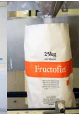
Säkituskone pakkaa automaattisesti kiteisenä toimitettavan fruktoosin 25 kilon säkkeihin.
