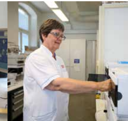
Danisco:n oma laboratorio palvelee asiakkaiden tarpeita. Laborantti Raija Purtilo sijoittaa ampulleja HPLC-analysaattoriin.
